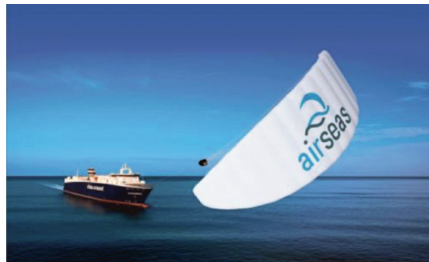
Fig. 17. Seawing sail on a cargo ship Ville de Bordeaux
