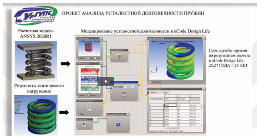
Рис. 6. Примеры научных разработок УрГУПС. Срок службы пружин, по результатам исследований и результатам расчетов в «n Code Design Life», составляет 25,27 года ≈ 25 лет подтвержден
